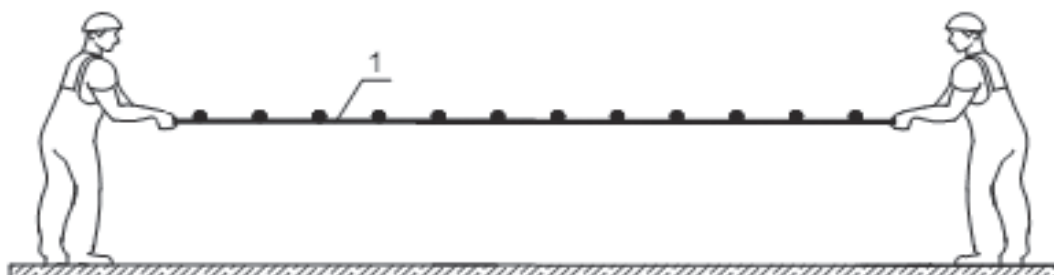
Установка нижних сеток
