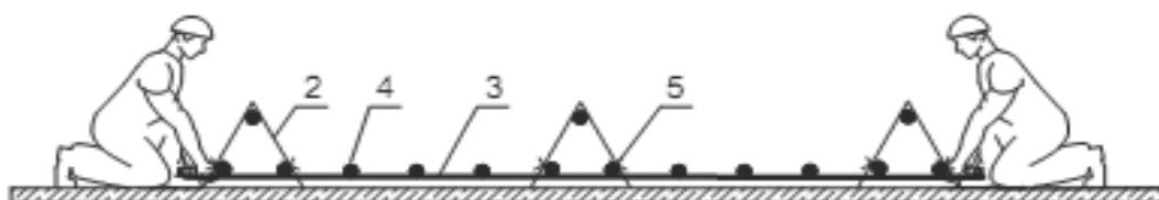
Установка каркасов поддерживающих верхнюю сетку
