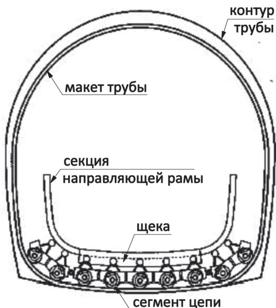
Рисунок 7 – Первый этап сборки навивочной машины
