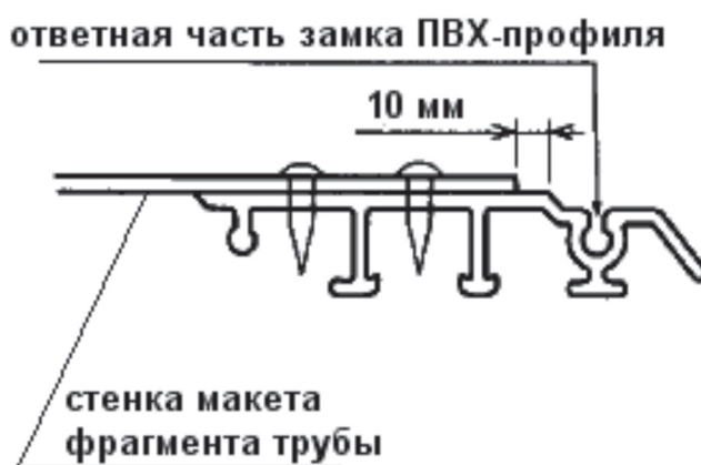
Рисунок 6 – Фиксация кольца из ПВХ-профиля в макете фрагмента трубы
